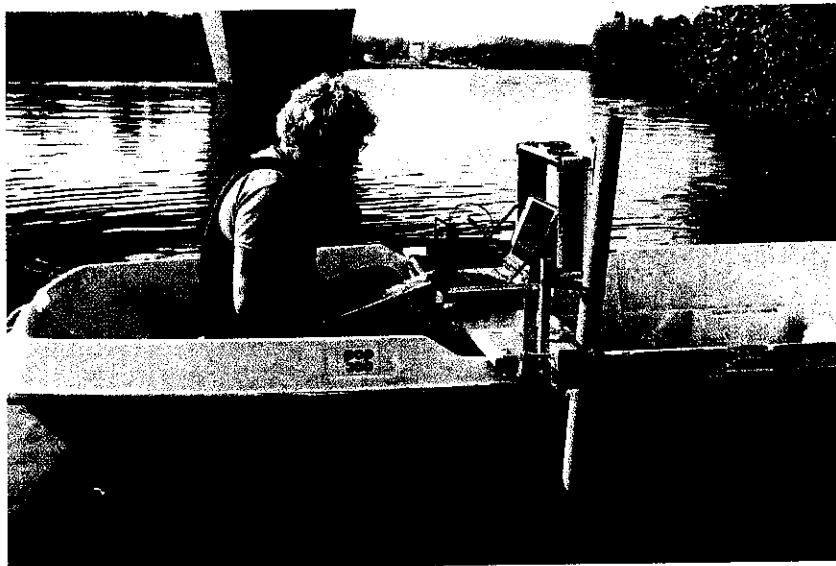
Fig. 5 : Installation de mesure bathymétrique (cliché : GRAS).
