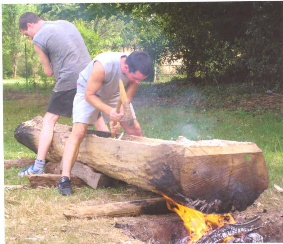
Ci-dessus: le tiers supérieur de la grume est débité en tranches à l'aide de coins insérés aux extrémités. Pour faciliter l'enfoncement de ces coins de bois, une saignée pointillée de petits trous est réalisée à l'aide d'un bois de cerf.
