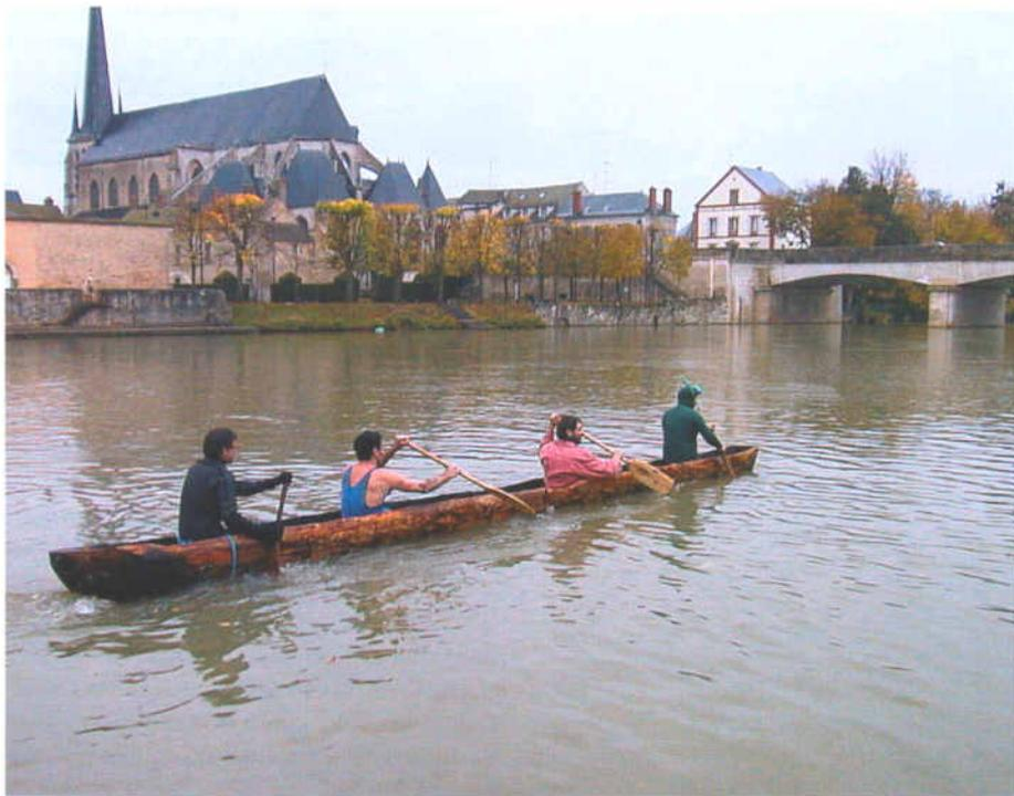
Essai sur le Loing, à Nemours, d'une pirogue de 8,40 mètres, construite par le GRAS en 1999. Cette embarcation monoxyle, dont l'avant ne soulage pas suffisamment, ne pourrait pas affronter sans danger le clapot marin.
